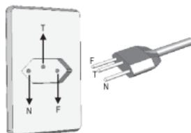
O encaixe do plugue do ATS Laser na tomada deve ser conforme essa figura.
