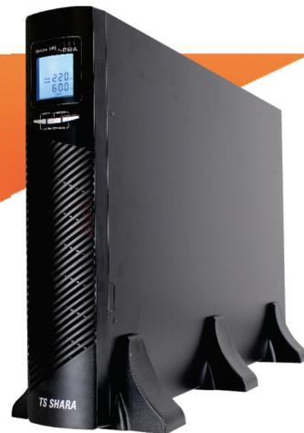
A linha UPS SENNO ST 3KVA MONO modelo rack de dupla conversão foi concebida com alta tecnologia para conversão de energia em alta frequência, utilizando processador DSP/PFC e blocos IGBTs inteligentes, este equipamento é capaz de converter a energia elétrica monofásica ou bifásica em tensão estabilizada senoidal pura para a potência de 3KVA tanto nas tensões 115V ou 220V.
