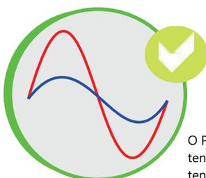
O PFC Ativo faz com que a corrente tenha forma de onda semelhante à tensão (esquerda).
