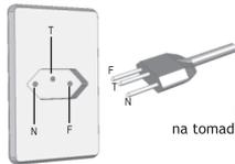
O encaixe do plugue do Nobreak na tomada deve ser conforme essa figura.
